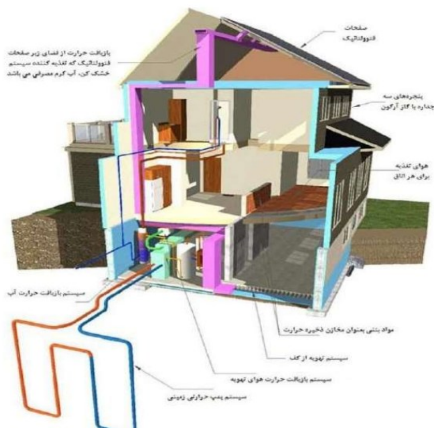
شکل ۲-۷ طرحی از فناوری بکار رفته در ساختمان انرژی صفر
