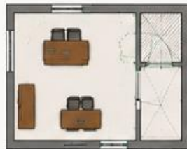
سطح شیشه \geq 1/8 سطح کف
