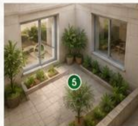
سطح شیشه \geq 1/8 سطح کف
