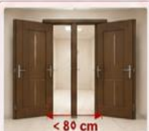
پهنای مفید هنگام باز شدن لنگه فعال کمتر از ۸۰ سانتی متر
