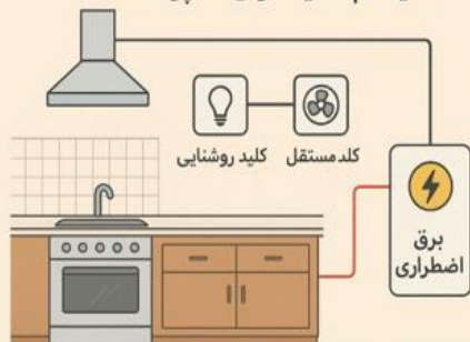
سیستم تخلیه هوای آشپزخانه
